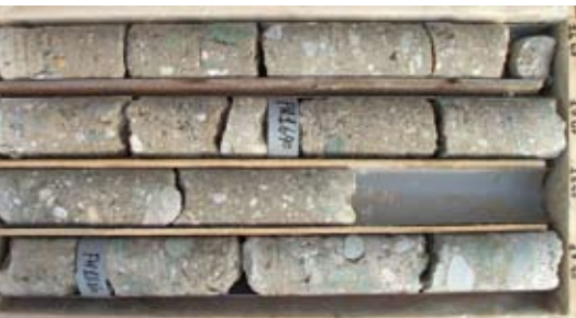
Figura 39 - Campioni prelevati con carotiere T6S con diametro da 131 mm
