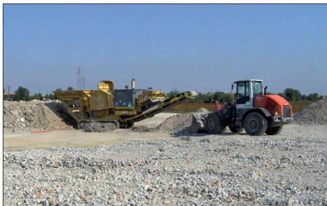
Foto 2 - Ripresa fotografica di un impianto mobile in attività in area di cantiere.
