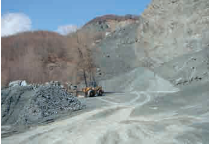
Foto 5 – Cava di ofiolti Groppo di Gora (Comune di Bardi): falda detritica gravitativa in formazione (Foto Pelosio)
