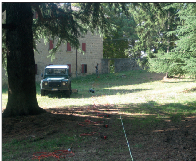
Figure 12a e 12b: Stendimento sismico a sinistra, e prova penetrometrica, a destra, nell'area adiacente il borgo medievale di Riola di Labante.
