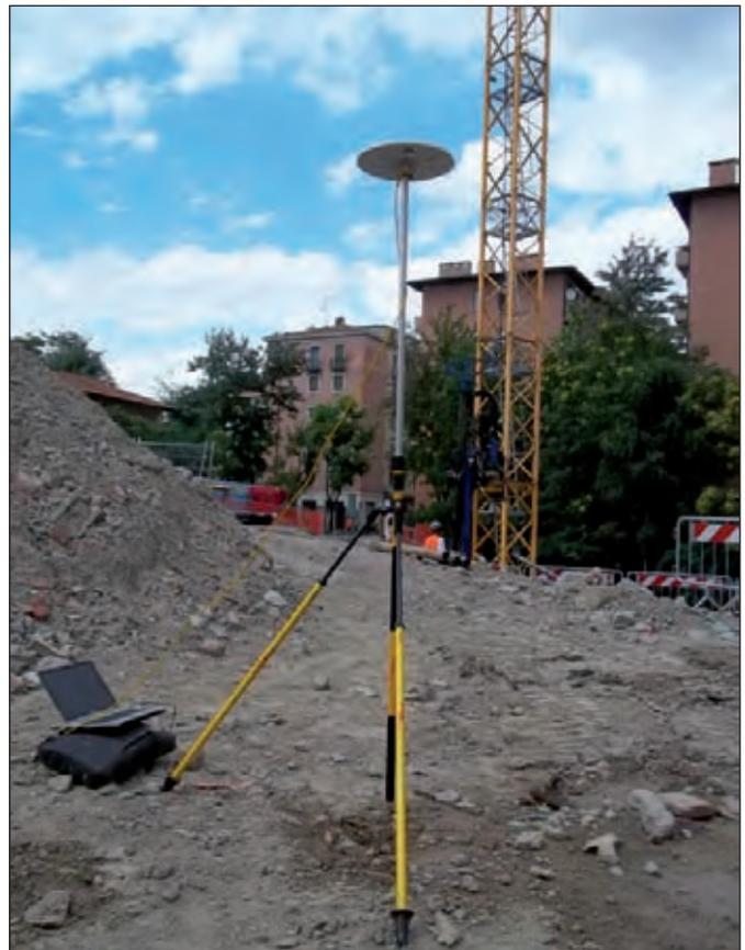
Figura 5 – Antenna GPS in fase di acquisizione
