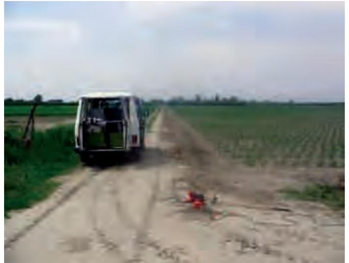
Figura 8 – Particolare dell’acquisizione dei dati sperimentali (Re.Mi. ed ESAC) utilizzando geofoni 3D a bassa frequenza di taglio (4.5 Hz).
