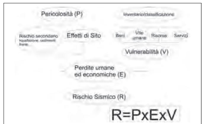
Figura 3 – Definizione semplificata del rischio sismico (R).
