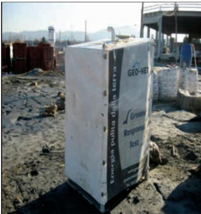
Figura 4 - Strumentazione per il test di risposta termica dei terreni
