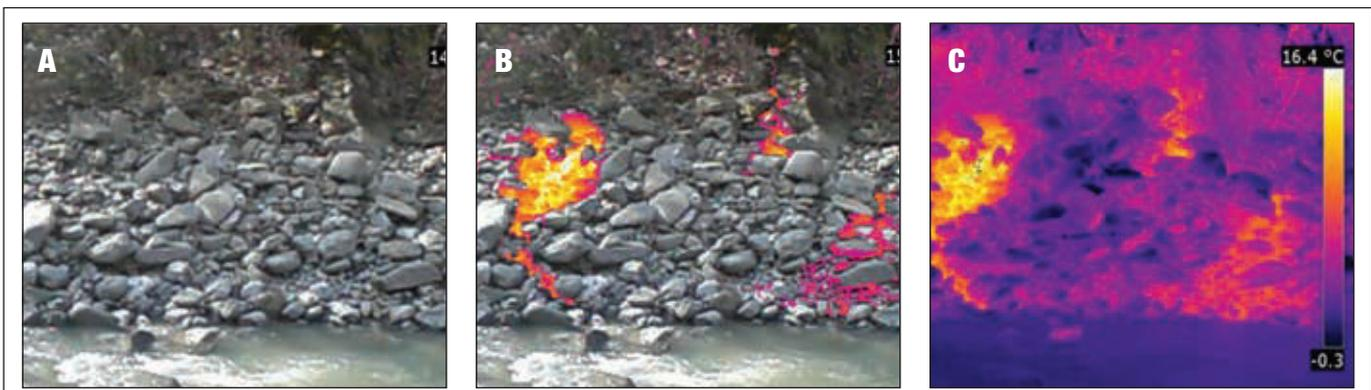
Figura 9 - Set di immagini del rilievo di Febbraio 2011: A) immagine nel campo visibile; B) immagine mista nel campo visibile ed infrarosso termico; C) immagine nel campo dell'infrarosso termico
