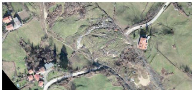
FIGURA 38 - Immagine zenitale della parte medio bassa della frana (foto gentilmente concessa dal STB Affluenti del Po- volo Aerodron, [www.aerodron.com](http://www.aerodron.com)). Notare la traslazione verso valle della strada
