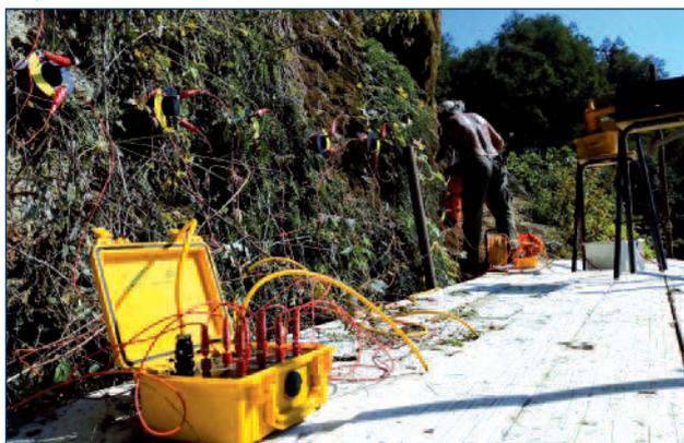
nerata dalla stessa, si è proceduto alla misura della resistività elettrica lungo tre linee di misura (Fig 37).
