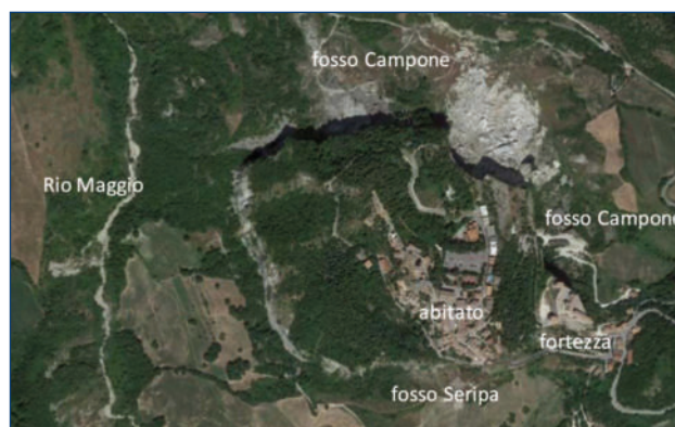
Figura 2. La placca rocciosa quadrangolare di San Leo vista da satellite (Google Earth) "galleggiante" sui terreni argillosi circostanti. Nello spigolo nord-est sono visibili i segni del crollo del 2014.
