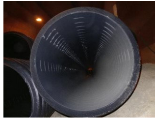
Tube di fondo phi 400 microfessurato con portata di 366 l/s
