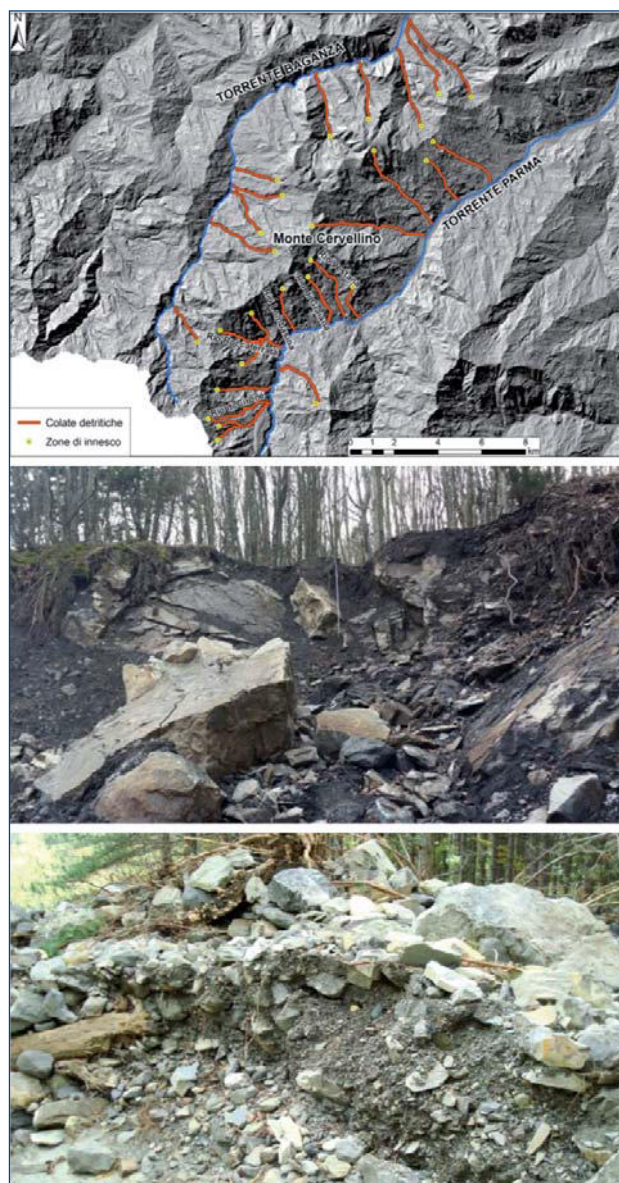
Figura 3. Censimento delle colate detritiche nella Provincia di Parma innescate durante l'evento del 13 ottobre 2014; esempio di una zona di innesco di colata detritica documentata nell'area; zona di deposizione di una colata detritica, tipica gradazione inversa.
