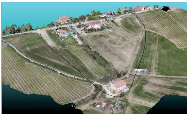
Figura 6. Modello tridimensionale del terreno (DTM) ottenuto da rilievi con drone. La freccia indica il nord.
