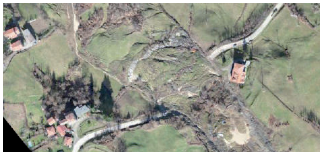
FIGURA 38 - Immagine zenitale della parte medio bassa della frana (foto gentilmente concessa dal STB Affluenti del Po- volo Aerodron, www.aerodron.com ). Notare la traslazione verso valle della strada
