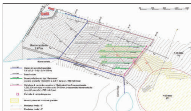
IMMAGINE 1 - Il disegno illustra il sito di intervento indicando le zone più sensibili e soggette a potenziale dissesto e gli interventi di consolidamento idrogeologico effettuati
