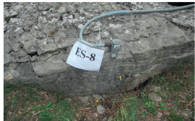
Fig. 24 - Estensimetro a filo. L'estensimetro a filo misura l'apertura della frattura attraverso un filo in acciaio in tensione. L'affidabilità è discreta, relativamente ingombrante come strumento necessita, per la presenza di fili, di un'adeguata protezione
