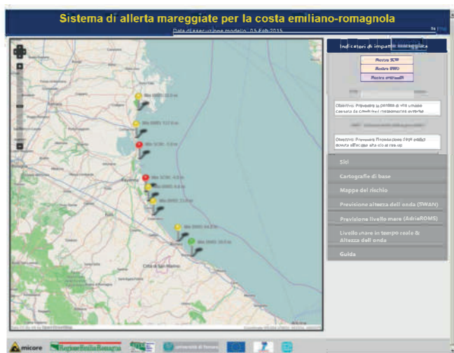
Fig. 8 - L' interfaccia web del sistema di allertamento EWS permette di visualizzare, con una scala colori verde, giallo rosso, il livello di rischio atteso durante l'evento; la mattina del 5 Febbraio 2015, 7 degli 8 siti del modello, hanno raggiunto un livello di rischio medio alto (rosso e giallo) (8a). Per ciascun sito è possibile consultare l'evoluzione prevista dei 2 indicatori di rischio definiti per la costa regionale: il Safe Corridor Width (SCW), che indica l'ampiezza di spiaggia asciutta utile per un eventuale evacuazione in sicurezza, e il 'building water distance' (BWD), che indica la distanza tra l'acqua e le infrastrutture retrostanti. Nel grafico di fig. 8b è riportato l'andamento dell'indicatore SCW presso il sito di Lido di Classe: lungo l'asse orizzontale è rappresentato il tempo(dalla mezzanotte del 5 febbraio alla mezzanotte dell'8 febbraio) e in quello verticale l'ampiezza del SCW, corrispondente con la porzione asciutta della spiaggia; il passaggio tra rischio basso e medio è posto quando il SCW è uguale o inferiore a 10 metri, il passaggio tra rischio medio ed elevato è posto quando il SCW è uguale o inferiore ai 5 metri.
