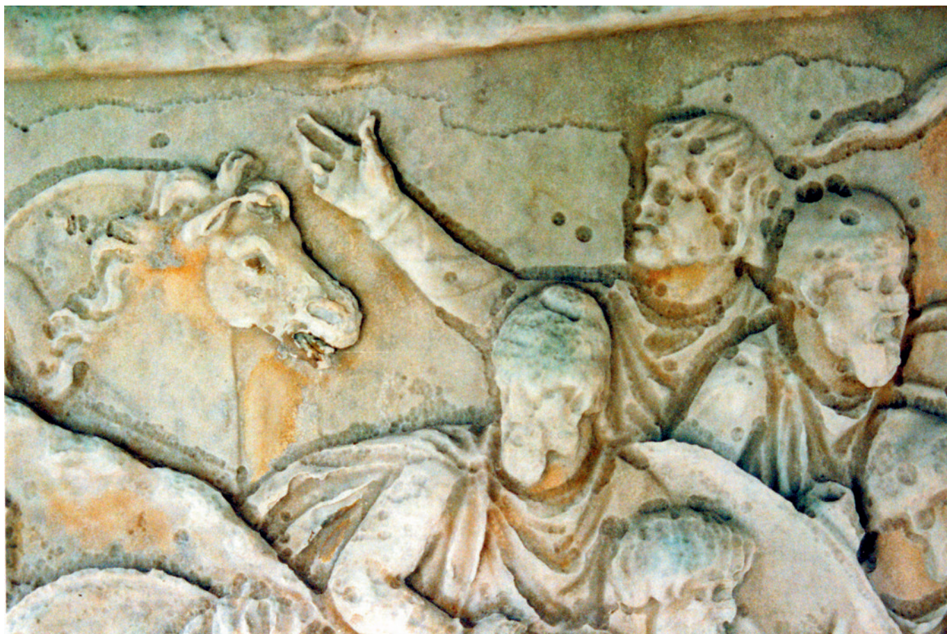
Fig. 14 – La patina bruna a ossalati di calcio presente su moltissimi monumenti antichi [in marmo o in calcare] situati all’aperto in aree urbane oggi molto inquinate, aggredita dalle deposizioni acide [solide, liquide e occulte] appare oggi in via di dissoluzione. La patina è spesso, come nel caso qui presentato, associata a numerose piccole cavità [cfr. fig. 6 e 7]. Queste piccole cavità a sezione circolare e a forma emisferica visibili in più punti del rilievo [nel testo emimicrosfere] sono ciò che resta delle sedi degli ascocarpi, vale a dire dei corpi fruttiferi, di licheni semiendolitici che colonizzavano la superficie del monumento in passato, quando i livelli di inquinanti aereodispersi erano molto inferiori a quelli odierni e i licheni godevano ottima salute anche nel cuore delle città. Queste piccole cavità una volta abbandonate possono col tempo venire allargate dall’acqua di pioggia, mediante un fenomeno di microcarsismo. La coalescenza di due o più emimicrosfere vicine può dar luogo a: i - emisfere più grandi [ben visibili sulle teste dei due soldati in alto a destra e in basso a destra]; ii - ad avvallamenti a bordi zigrinati semicircolari [come quello osservabile in alto nella foto, ovvero in modo ancora più evidente in corrispondenza della spalla destra del soldato con l’ampio mantello in basso, quasi al centro della foto]; iii - quando le emimicrosfere sono allineate si possono formare microkarren [caratteristici dei bordi del bassorilievo dove le microfrazioni lasciate dallo scalpello dell’Artista risultarono siti più idonei di altri ad ospitare le diaspore. Si noti, ad esempio, quello in corrispondenza della criniera del cavallo in alto a sinistra]: osservando questi solchi con attenzione si può notare che hanno origine da numerosissime emimicrosfere allineate. Questo insieme di motivi superficiali è presente sia su molti monumenti conservati nelle raccolte museali [che hanno trascorso nelle epoche passate periodi sufficientemente lunghi all’aperto], sia su calcari e marmi in campo, vale a dire su affioramenti naturali [Colonna Traiana, particolare, Roma, marmo di Lun].
